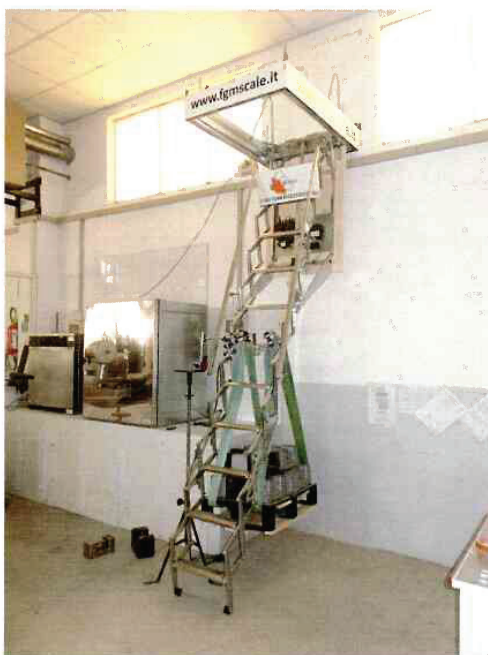
Foto 2: prova di carico statica – gradino centrale
