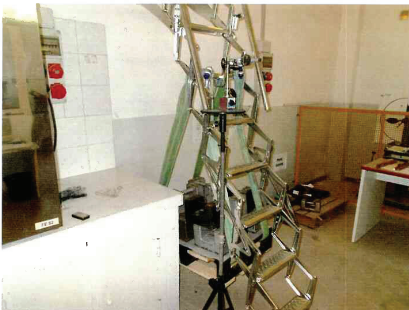
Foto 3: prova di carico statica – gradino centrale, particolare comparatore
