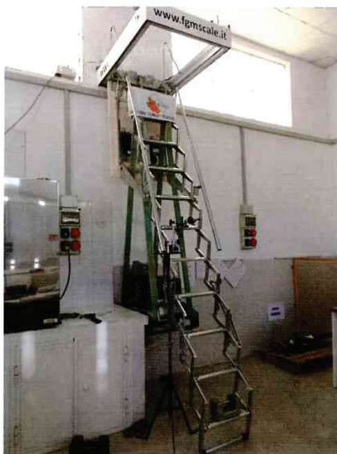
Foto 1: prova di carico statica – gradino superiore
