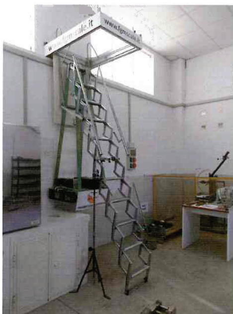
Foto 1: prova di carico statica – gradino superiore
