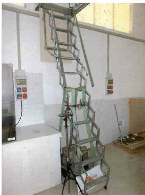
Foto 2: prova di carico statica – gradino centrale
